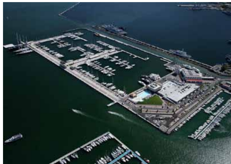
Qui sopra: veduta aerea del Porto Mirabello a La Spezia. L'intero marina è stato costruito sull'acqua realizzando una penisola artificiale. In alto: alcuni maxi yacht all'ormeggio.
