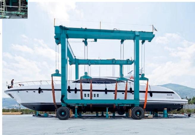
A sinistra, il cantiere di proprietà di Itn per le attività di riparazione e manutenzione. Sopra, il travel lift da 160 tonnellate che completa i servizi per la barca, insieme a due stazioni di rifornimento e alla possibilità di usufruire dei sommozzatori. A lato, il pianetto del marina.
